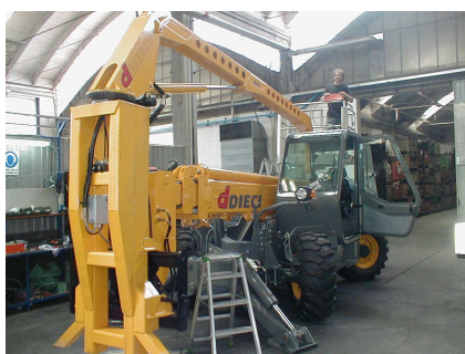
Pozitív kiegészítő kar személyemelő kosárhoz, 10 m hosszú, a gép felett tud mozogni
