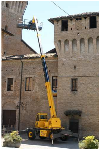
Pozitív kiegészítő kar személyemelő kosárhoz, 10 m hosszú, a gép felett tud mozogni
