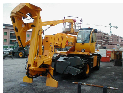
Pozitív/negatív kiegészítő kar személyemelő kosárhoz, 10 m hosszú, a gép felett és alatt is tud dolgozni
