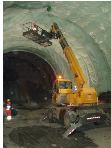
Pozitív/negatív kiegészítő kar személyemelő kosárhoz, 10 m hosszú, a gép felett és alatt is tud dolgozni
